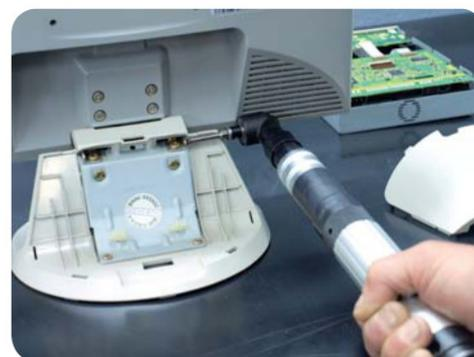
Cabezal en ángulo facilita la posición de trabajo en espacios reducidos o de difícil acceso.
